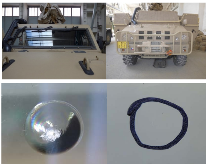
Pancéřové sklo poškozené ve tvaru oka.
