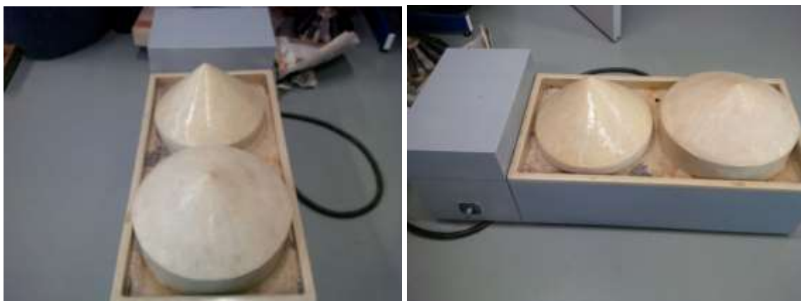
Kuželový magnet s rotující vnitřní částí
