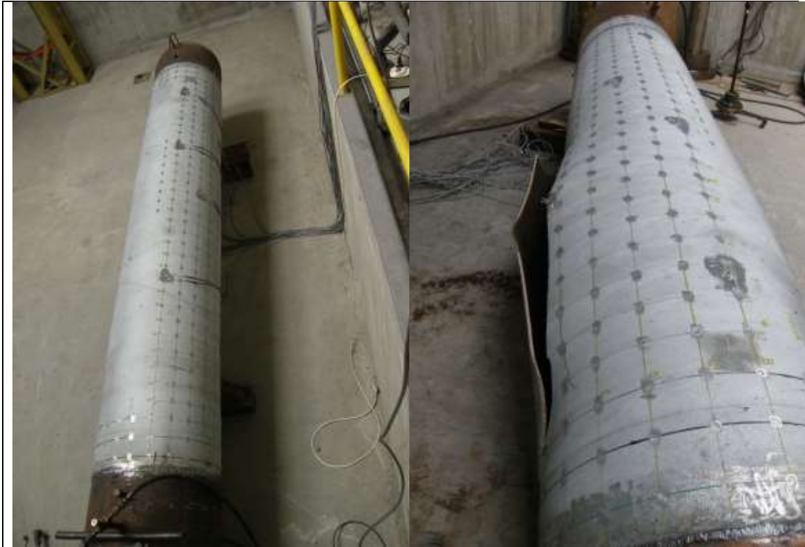
Testovaný výřez plynovodu před a po tlakových zkouškách. Pro testy bylo na celém segmentu plynovodu instalováno celkem 32 tenzometrických snímačů pro měření deformací.
