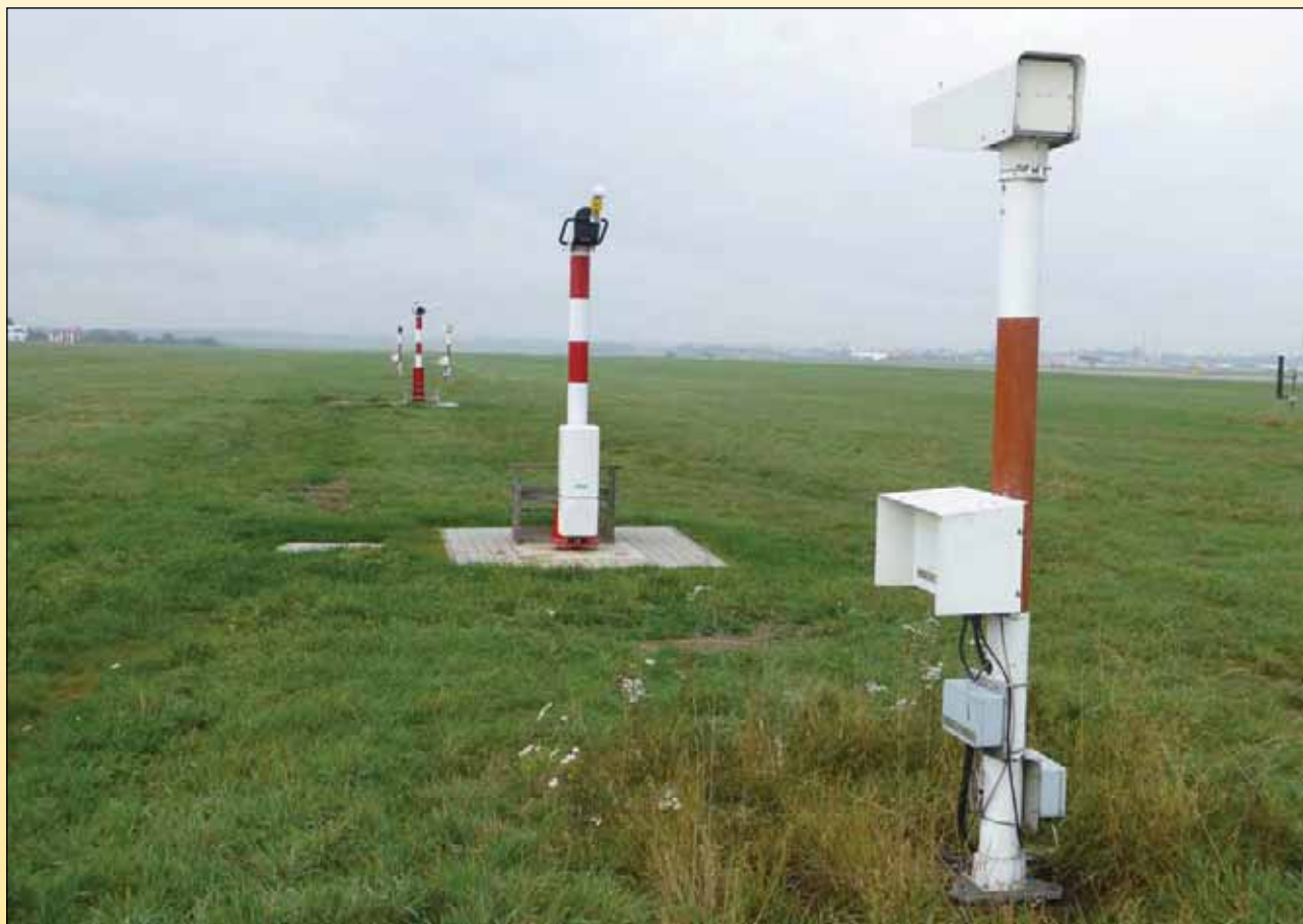
Starý typ (MITRAS double base, vpravo) a nový typ (LT31, vlevo) transmisometru (foto P. Černý).
