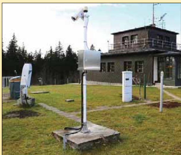
Laserový měřič výšky sněhové pokrývky – SHM 30 na MS Churáňov.
