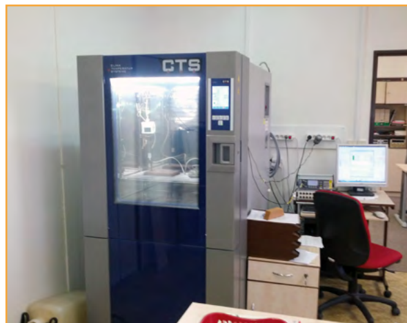
Kalibrace teploměrů v klimatické komoře CTS-200 s možností kalibrací v plynném prostředí při rozsahu teplot -60 až 100 °C.
