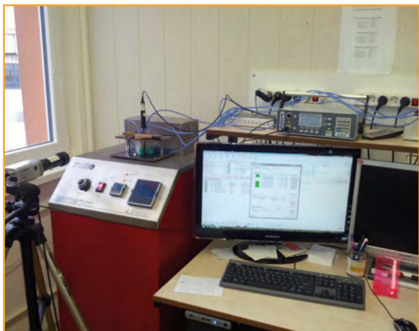
Kalibrace teploměrů v kapalinové lázni ISOTECH 785L pořízené pro možnost kalibrací v kapalném prostředí při velmi nízkých teplotách až -60\text{ }^{\circ}\text{C} .
