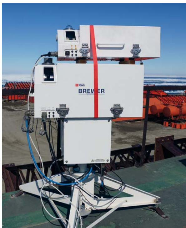
Brewerův spektrofotometr 199 při kalibraci. Základna Marambio, Antarktida, 2016.
