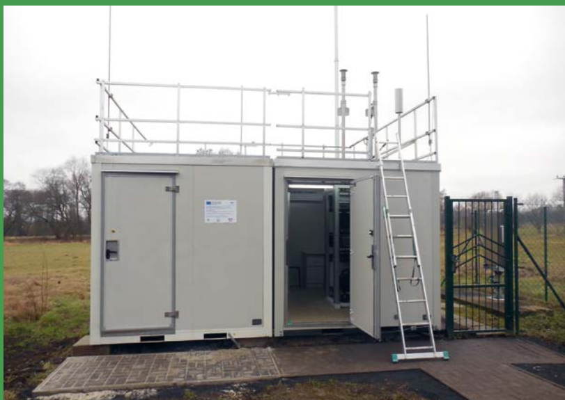
Instalace nového kontejneru a přístrojů pro měření UJČ a PM_{10} v rámci projektu Objektivizace stížností na zápach ve venkovním ovzduší Krušných hor a Ústeckého kraje – analýza pachových látek a studie zdravotních následků v Lomu.
