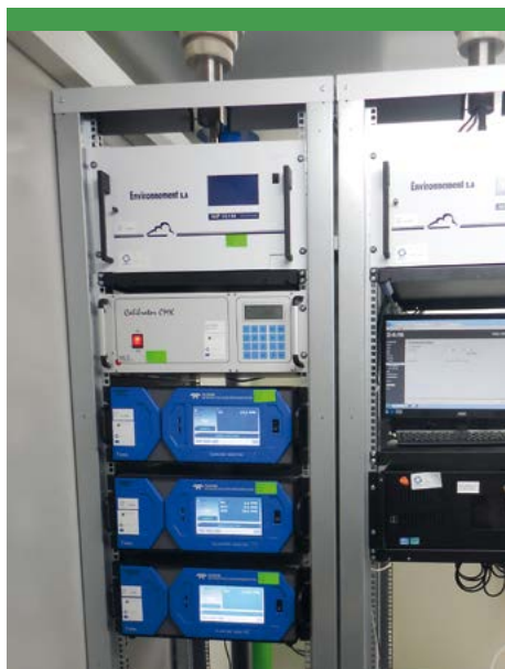
Instalace nového kontejneru a přístrojů pro měření UJČ a PM_{10} v rámci projektu Objektivizace stížností na zápach ve venkovním ovzduší Krušných hor a Ústeckého kraje – analýza pachových látek a studie zdravotních následků v Lomu.
