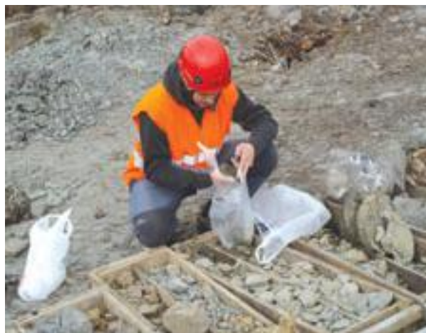
Odběr porušených vzorků z vrtného jádra v rámci diplomové práce, jejíž řešení probíhalo pod vedením ČGS.
