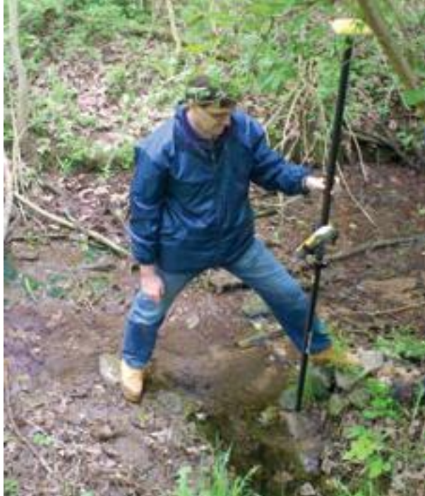
■ Přesné zaměření pramene pomocí GNSS přístroje Topcon.
