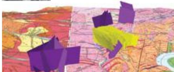
Vizualizace zlomů v rámci granodioritu a tonalitu slapského typu. Fialová – všechny povrchové zlomy, žlutá – zsz.-vjv. strmě uložený zlomový systém v rámci štolového patra.
