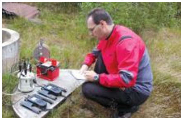
■ Terénní měření fyzikálně-chemických parametrů podzemních vod.
