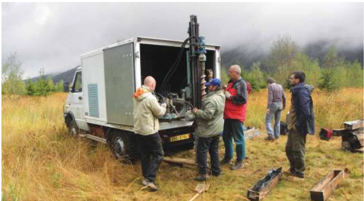
■ Odběr vzorků z odkaliště ve Zlatých Horách. Foto P. Rambousek.
