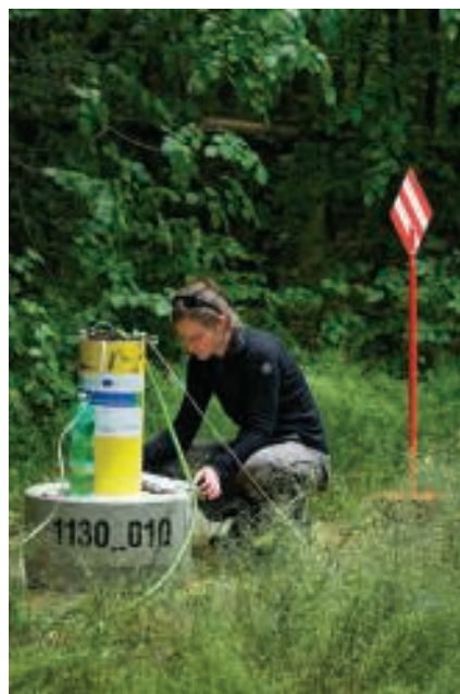
Odběr vzorků podzemních vod z výzkumného vrtu, projekt „Rebilance zásob podzemních vod“.
