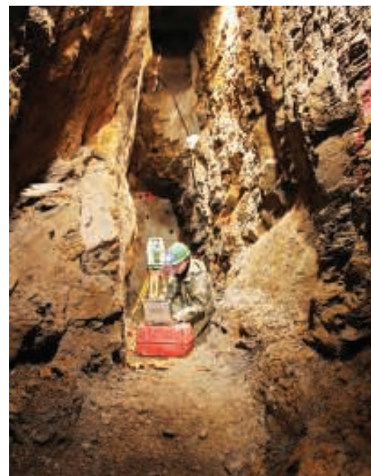
Laserové skenování středověkých důlních chodeb v Dippoldiswalde
