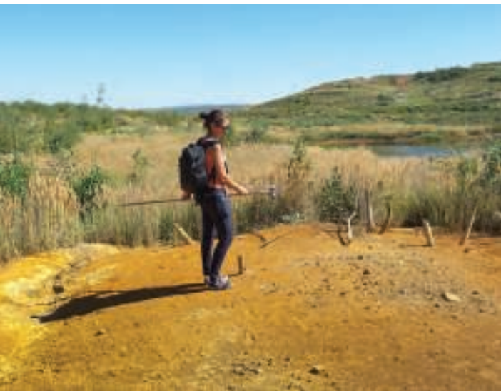
Sokolov (Česká republika): průzkum terénu a měření pozemním spektrometrem.
