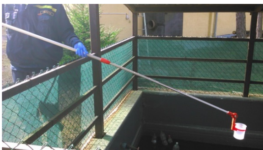
Nácvik odběru hladinového vzorku vody
