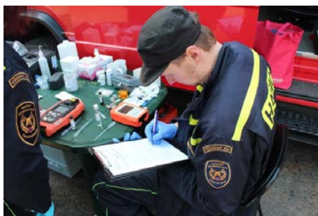
Terénní analýza neznámých kapalin přenosnými spektrometry
