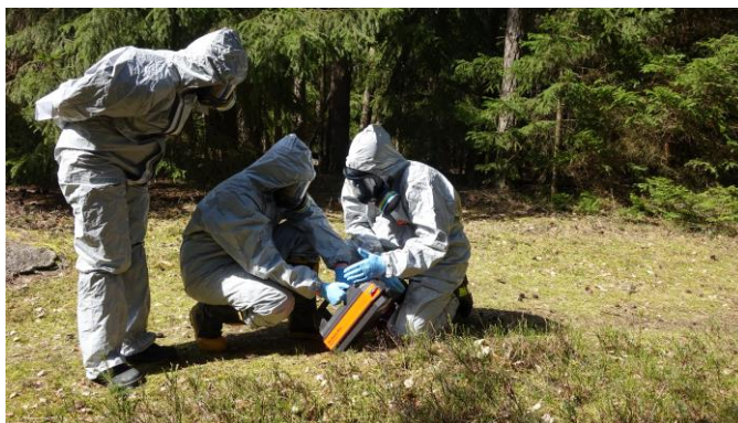
Detekce a identifikace neznámých těkavých látek v terénu
