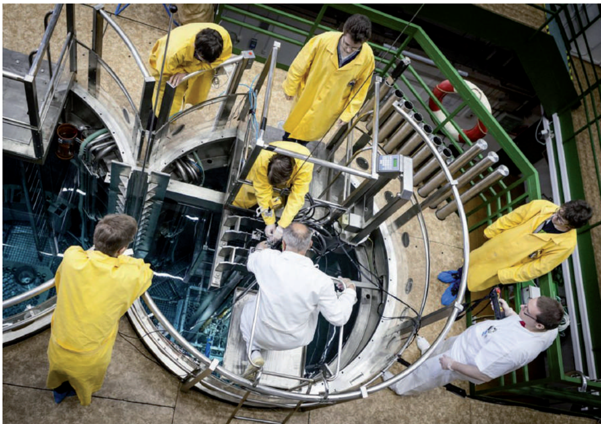
Testovací zařízení nové generace MONTE-1 u školního jaderného reaktoru VR-1 k testování detekčního vybavení monitorujících a zasahujících skupin při jaderných haváriích a vybavení sítě včasného zjištění, Sklenka, L., 2013–2015, VG20132015119
