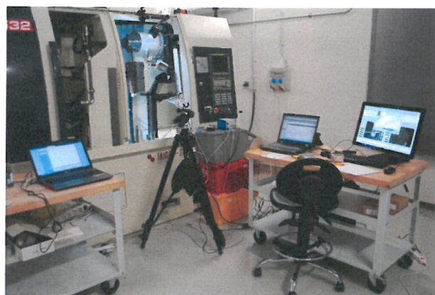
Měření teplotního chování stroje
