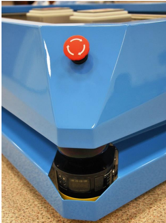
E-Stop tlačítko a laserový skener SICK v rohu omnirobotu
