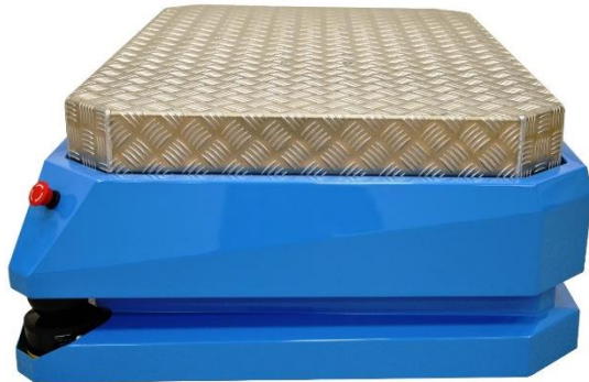
Prototyp omnirobotu se zvedací platformou v horní a spodní funkční poloze
