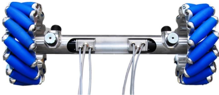
Náprava se všesměrovými koly a integrovanými pohony
