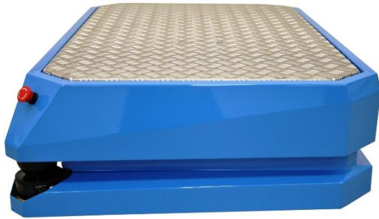
Prototyp omnirobotu se zvedací platformou v horní a spodní funkční poloze
