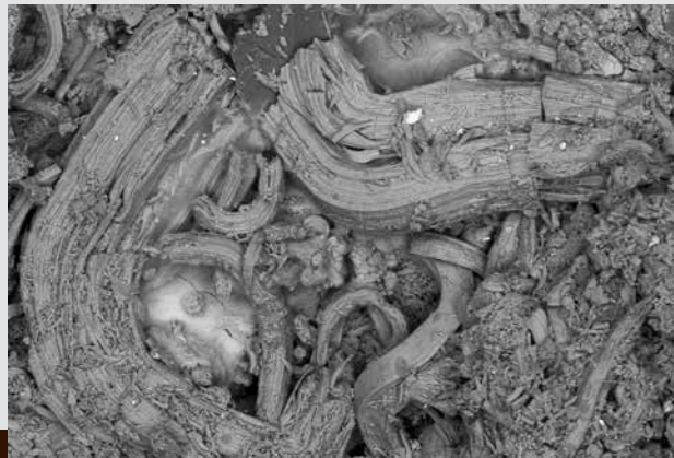
Povlaky oxidačních produktů na zlomku zvonu z archeologického nálezů (Pacov), elektronový mikroskop.
