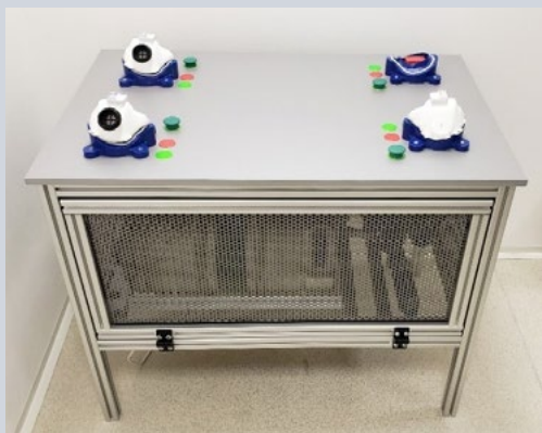
Obr. 101 NCK MATCA testovací zařízení na kontrolu kvality sériově vyráběných polomasek RP-95M.
