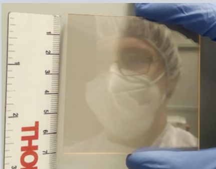
Obr. 115 TGG krystal s rozměrem 69×69 mm 2 .
