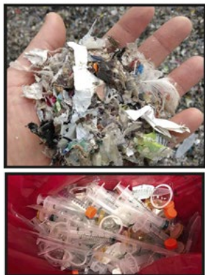
Obr. 55: Aparatura Golem pro plazmové zplyňování odpadu vyvíjené ve spolupráci s Ústavem fyziky plazmatu a firmou HVM Plasma, s.r.o., včetně možných zpracovávaných odpadů RDF (refuse derived fuel), tj. zbytkového směsného odpadu po vícestupňovém procesu třídění nebo nebezpečného bioodpadu.
