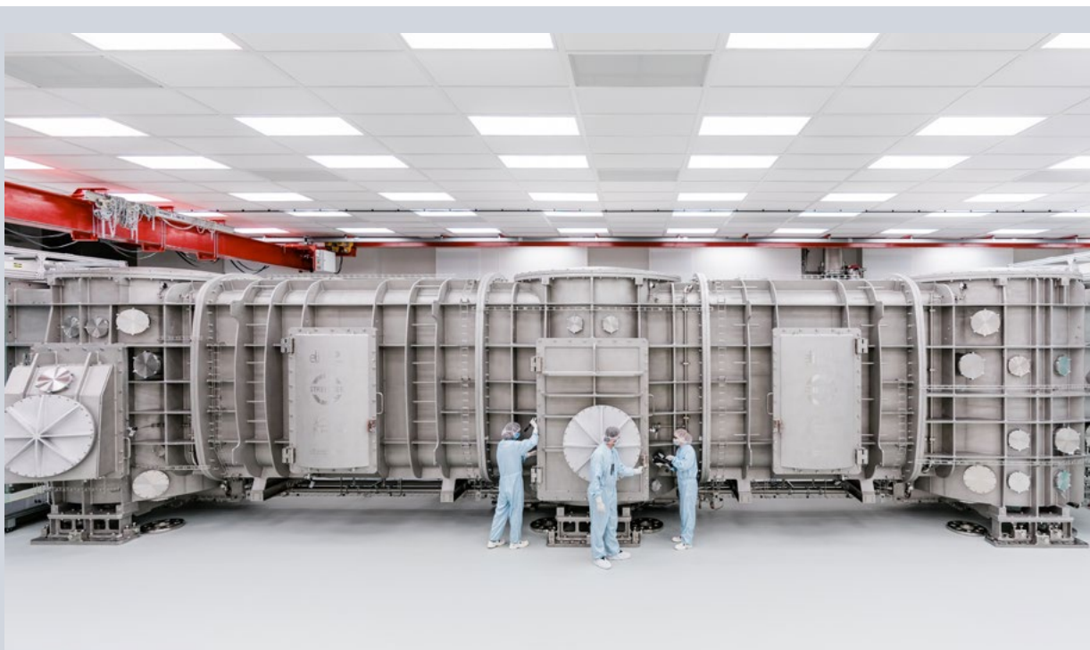
Obr. 165 Obří vakuový kompresor výstupních laserových pulsů systému L4 pro generaci optického výkonu 10 PW.
