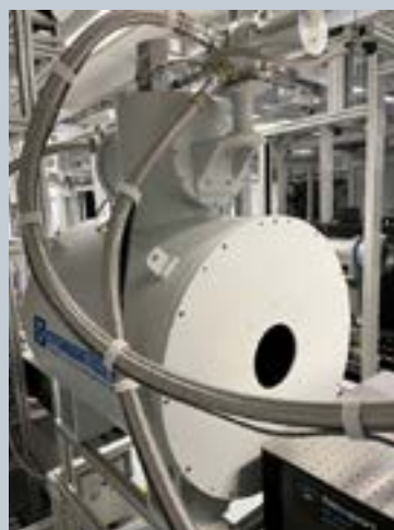
Obr. 2.5.6: Fotografie kryogenně chlazeného magnetu pro vyvíjený magneto-optický izolátor pro 100J pulzy
