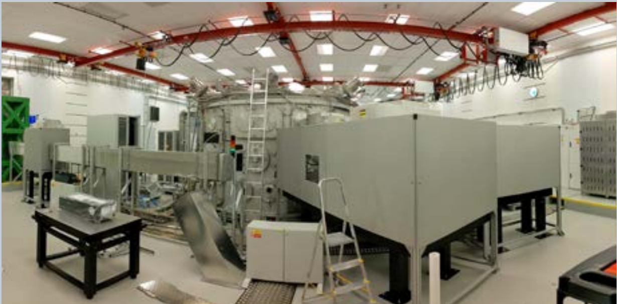
Obr. 2.6.15: Uspořádání L4n beamliny v experimentální hale E3. Vlevo: Beamlina se vstříkovacím bodem na zelené věži. Vpravo: Skříň obsahující finální optický systém pro záření L4n laseru do P3.
