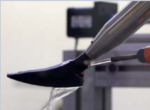
Obr. 2.5.9: Zpracování kloubního dříku technologií LSP
