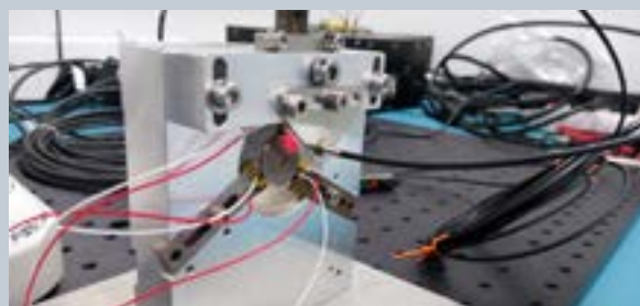
vpravo dole – Piezomechanismus pro družice LISA vyvíjený v naší Laboratoři pro testování a vývoj optických senzorů pro astronomii
