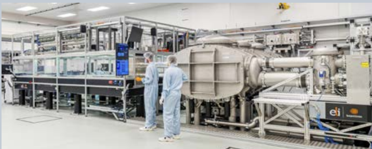
Obr. 2.6.17: Laserový systém L1 Allegra s opakovací frekvencí 1 kHz a výstupní délkou impulsu 15 fs
