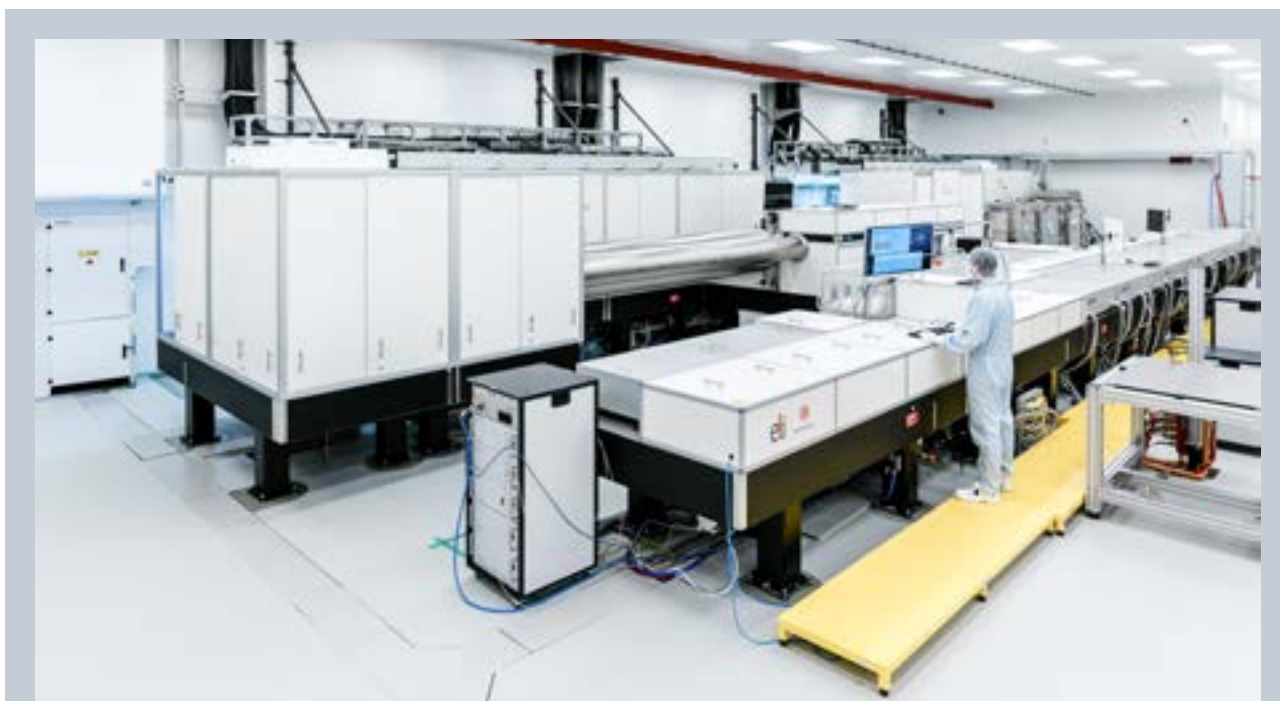
Obr. 2.6.24: Laserový systém L4-ATON, poskytující spektrálně širokopásmové ns pulzy s energií 1,5 kJ. V popředí je oscilátor a první stupně výkonového předzesilovacího řetězce na bázi OPCPA.
