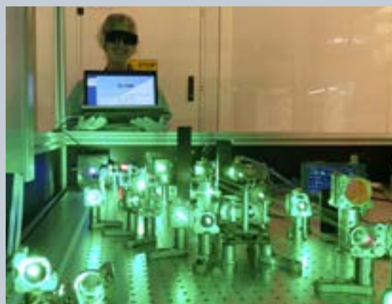
Obr. 2.6.18: Parametrický OPCPA zesilovač F-SYNC s výstupní energií pulzů 16 mJ a opakovací frekvencí 1 kHz
