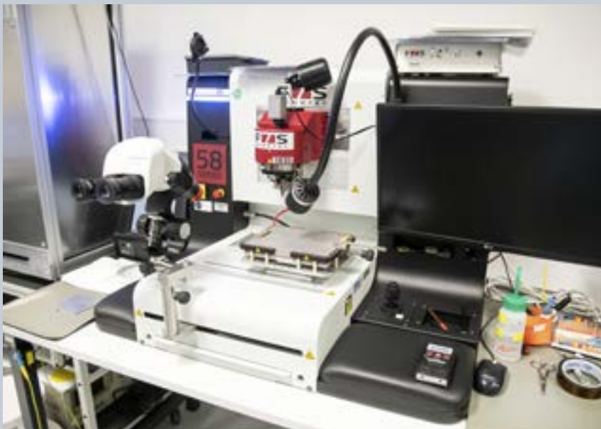
obr. 2.1.1: Automatická bondovací stanice F&S Bondtec Series 58 se standardní wedge-wedge hlavici 5830 se využívá zejména pro bondování gama ozářených testchipů na testovací PCB, jejichž vlastnosti jsou měřeny v rámci ITk strip Quality Assurance procesů. Bondování hliníkovým drátkem o průměru 25 mikrometrů se využívá též pro měření proudové stability ITk stripových senzorů či při studiu radiační odolnosti křemíkových detektorů typu LGAD.
