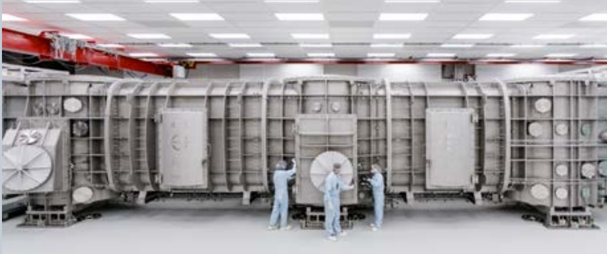
Obr. 2.6.25: 10 PW vakuový kompresor systému L4-ATON o délce 18 m a výšce 4 m, který se nachází ve finální fázi sestavování. Velikost výstupního svazku je 620 × 620 mm.
