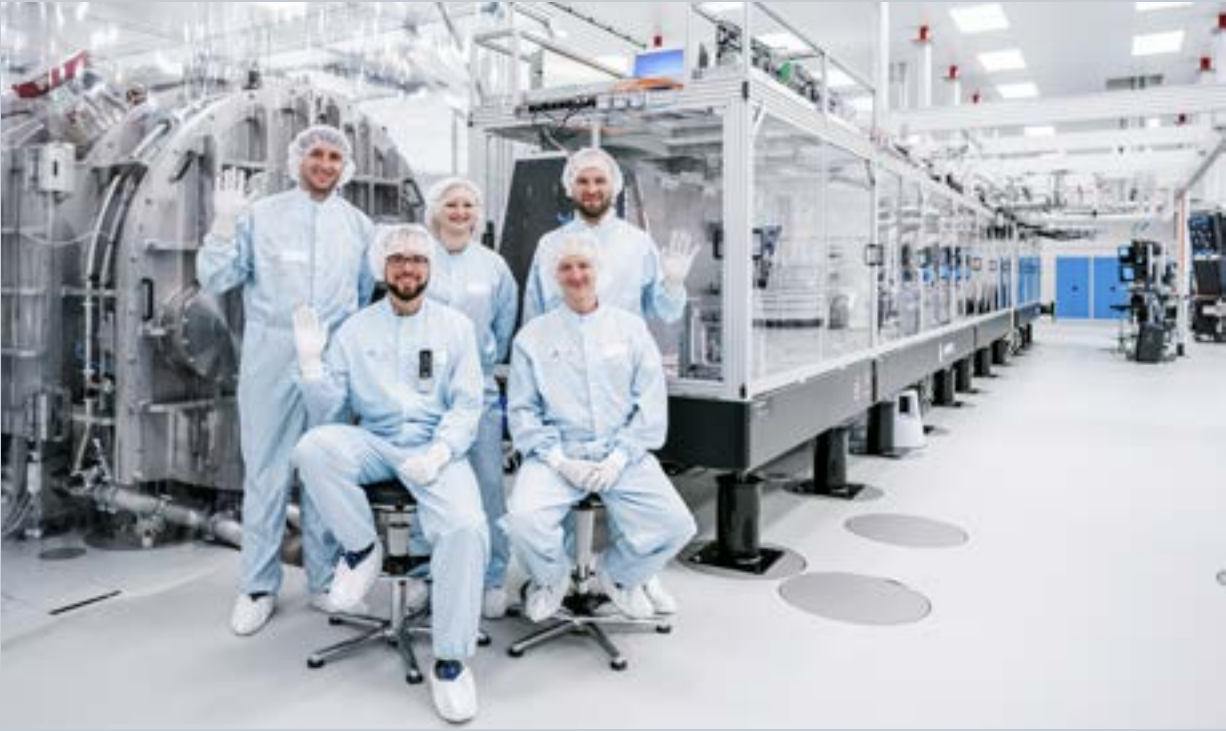
Obr. 2.6.5 Petawattový laserový systém L3-HAPLS poskytující energii výstupních pulsů 30 J a délku 30 fs.
