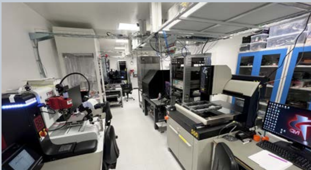
Obr. 2.1.3 Čistá laboratoř pro vývoj a testování polovodičových detektorů částic, ve které se v současnosti studují zejména křemíkové stripové senzory projektu ATLAS Inner Tracker.
